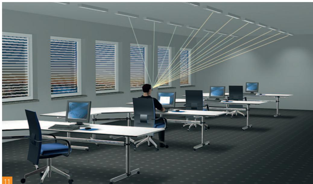
[11] Das UGR-Verfahren berücksichtigt alle Leuchten der Anlage, die zu einem Blendeindruck beitragen, sowie die Helligkeit von Wänden und Decken. Das Ergebnis führt zu einem UGR-Wert. (© licht.de)
