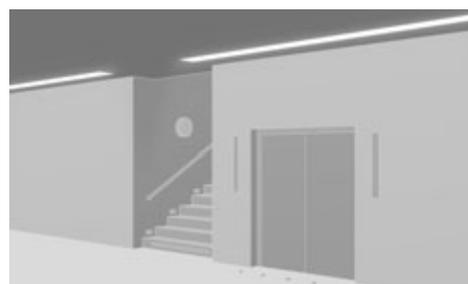
**Lichtkanalsysteme** bieten hohe Flexibilität: So können zum Beispiel Langfeldleuchten für die Allgemeinbeleuchtung mit Hochleistungsstrahlern für die Akzentbeleuchtung kombiniert werden. Lichtkanalsysteme eignen sich besonders gut für Flure, Foyers und Konferenzräume.
