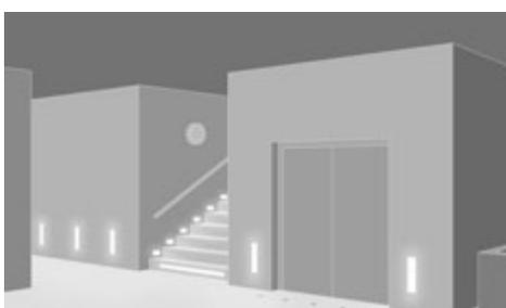
**Wand- und Bodeneinbauleuchten** ordnen sich der Architektur unter. Sie werden zur Lichtführung im Gebäude eingesetzt oder setzen Wände und Säulen in Szene. Im Treppenhaus sorgen an- oder eingebaute Wandleuchten für bessere Orientierung und mehr Sicherheit. Sie bringen zusätzliches Licht auf die Trittstufen.
