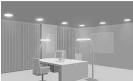
**Downlights** ordnen sich mit schlichtem Design der Architektur unter. In breitstrahlender Ausführung werden sie für die Allgemeinbeleuchtung in Fluren und in Büros eingesetzt. **Stehleuchten** sind flexibel. Sie kombinieren häufig direkte und indirekte Beleuchtung und sollen individuell dimmbar sein.
