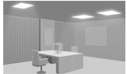
**Deckenanbauleuchten, mit lichtlenkenden Mikrostrukturen** ausgestattet, sorgen für eine homogene und blendfreie Lichtverteilung. Sie können deshalb auch direkt über Arbeitsplätzen angeordnet werden und eignen sich für eine raumbezogene Beleuchtungsplanung.
