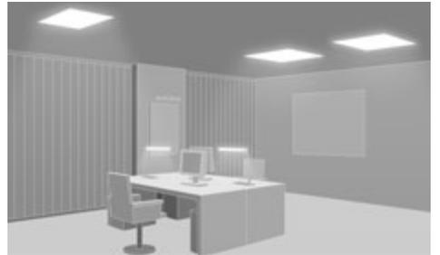
**Schreibtischleuchten** können die Arbeitsplatzbeleuchtung ergänzen. Sie spenden zusätzliches Licht auf der Arbeitsfläche und erleichtern diffizile Sehaufgaben. Damit das zusätzliche Licht individuell eingestellt werden kann, sollen Schreibtischleuchten dimmbar und mit einem beweglichen Arm ausgestattet sein.
