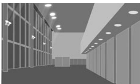
**Spiegelwerfer-Leuchten** erzeugen aus der Höhe hohe Beleuchtungsstärken und spielen ihre Vorteile vor allem in hohen Räumen, Foyers und Treppenaufgängen aus. Ein lichtstarker Strahler wirft das Licht auf einen in der Regel leicht konvex geformten Spiegel, der das Licht in den Raum streut.
