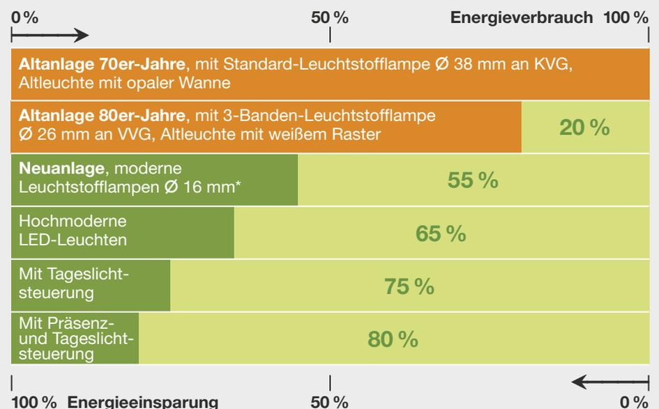
\* Leuchtstofflampe an EVG mit sehr geringer Verlustleistung, energieeffiziente direkt oder direkt/indirekt strahlende Leuchten mit moderner Lichtlenktechnik.
