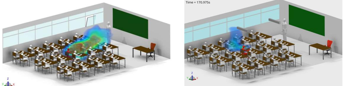
Abbildungen 2 und 3: Ausbreitung der Aerosole ohne und mit aktiver Luftentkeimung
