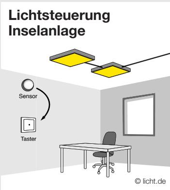
Inselanlagen mit erweiterten Funktionen werden in der Regel mithilfe von Sensoren ohne Tasten realisiert. Durch eine einmalige, lokal durchgeführte Programmierung lassen sich Energieeinsparungen und ein höherer Nutzerkomfort erreichen.
