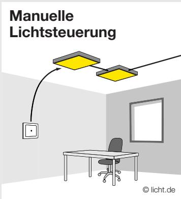
Manuelle Steuerungen, wie einfache Lichtschalter, erfordern keine besondere Inbetriebnahme. Ihre Funktion wird bereits durch die fachgerechte Installation gewährleistet.
