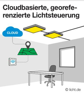
Mithilfe der Cloud lassen sich Komponenten lokalisieren und individuell programmieren. Nach Installation der Beleuchtungskomponenten werden sie an ein Netzwerk angebunden (drahtlos und kabelgebunden möglich). Anschließend wird das ganze System mit einer Cloud-Plattform verknüpft.
